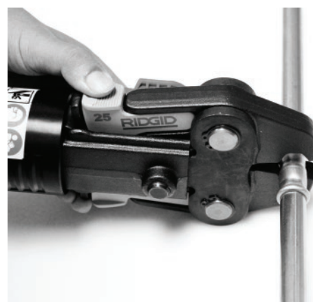
图5 打开剪式压接钳
