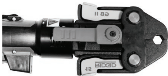
图3 完全闭合/锁紧的安装销
