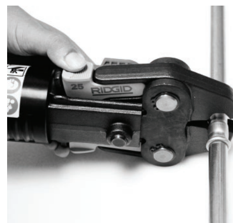
图5 打开剪式压接钳
