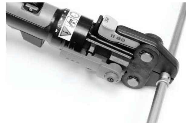
图6 将剪式压接钳扣住管件
