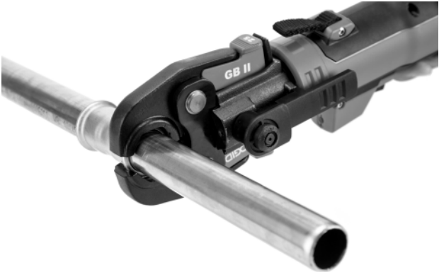
图6 将剪式压接钳扣住管件
